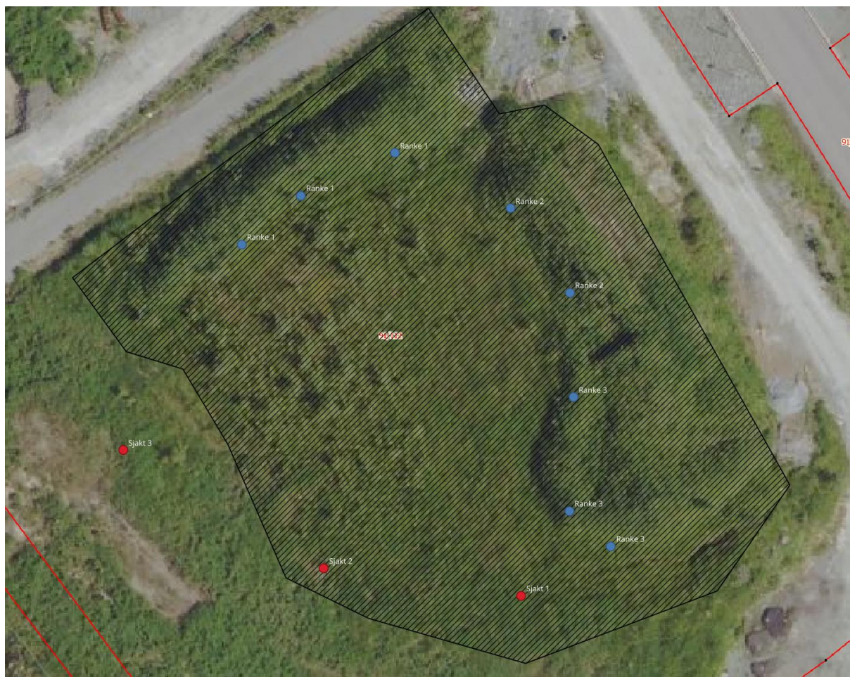
Kart: Avtakingsareal markert med skravering. Røde punkter angir sjaktene 1-3. Blå punkter viser uttakssteder for jordprøver fra jordrankene. Det er analysert blandeprøver fra ranke 1, 2 og 3.
