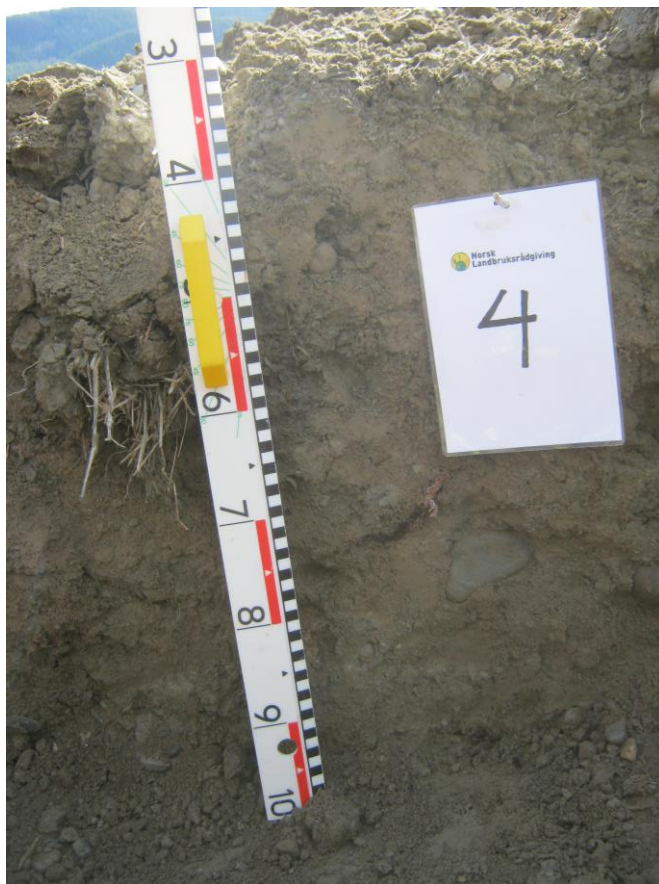
Bilde: Sjakt 4. Konstruert jordprofil med en del stein. Spor etter plogsjikt på ca. 20 cm.
